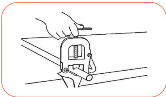
3º- Monte a tarraxa observando a colocação correta do cossinete, coloque-a no tubo fazendo uma pressão com uma das mãos e girando a ferramenta no sentido horário.
