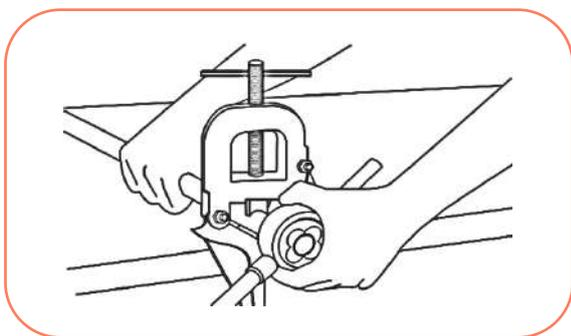
4º- O desenvolvimento da rosca deverá ser executado dando uma volta para a frente (sentido horário) e retornando um quarto de volta. A rosca desenvolvida no tubo deve ter o mesmo comprimento da bolsa onde for interligada;
