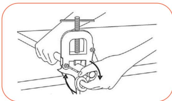
6º - Retire o tubo da morsa e rosqueie o tubo com a conexão. O aperto da rosca deve ser feito de forma manual sem auxílio de qualquer tipo de ferramenta.
