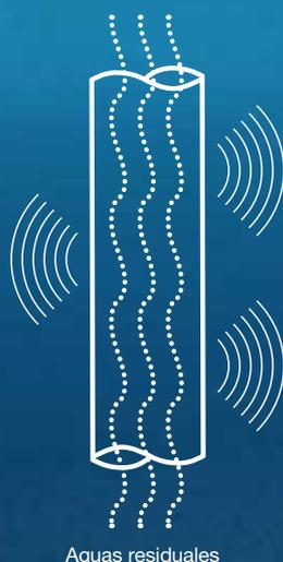
El sonido en el aire es la cantidad de ruido del agua que pasa a través de una tubería que se puede escuchar si se está en la misma habitación en la que está instalada la tubería.
