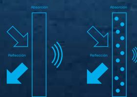
La composición del material de las tuberías influye en la cantidad de ruido que se absorbe. Los materiales flexibles absorben las vibraciones causadas por el agua que fluye.
