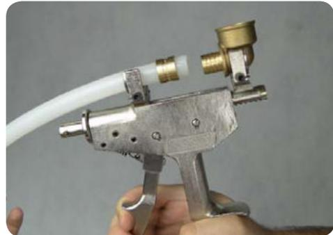
d) Pressione até que o anel encoste na conexão.
