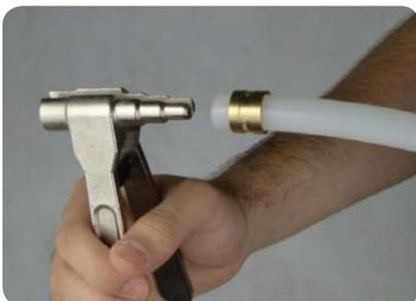
b) Introduza a conexão na bolsa do tubo. Deixe espaço de aproximadamente 2 mm entre o final do tubo e a conexão.
