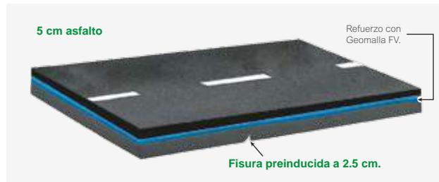
En un ensayo de propagación de fisuras, las Geomallas de Fibra de Vidrio soportan entre 5 y 10 veces más ciclos de carga que una muestra patrón sin refuerzo, mientras que la Geomalla sintética (Poliéster-PET) solo soporta 1.5 veces más ciclos de carga, hasta que la fisura se propaga a la superficie.
