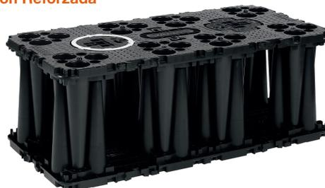
El análisis de la resistencia a cargas verticales y laterales de AquaCell se lo realiza contemplando como carga actuante máxima, la que produce un vehículo pesado de clase SLW60, el cual transmite al terreno una carga puntual de 10 t por neumático.
