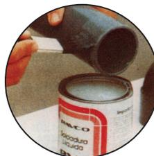
4.- Aplique generosamente soldadura líquida al exterior del extremo del tubo por lo menos en un largo igual a la campana de la conexión.
