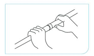
4º Após a fusão da luva em uma das pontas do tubo, coloque o bocal macho na outra bolsa da luva e mantenha o dobro do tempo recomendado na tabela de tempo de termofusão, retirando o termofusor em seguida.a tabela de tempo de termofusão, e introduza a luva no tubo aquecido.
