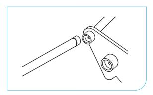
**6º** Por fim, insira imediatamente a ponta do tubo na bolsa da luva, pressionando o tubo para sua posição original na canaleta na parede.
