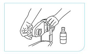
**2°** Corte o tubo no tamanho desejado utilizando a tesoura, evitando assim as rebarbas.
