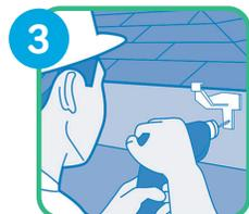
3 Realice la colocación de los soportes con una separación de 40cm uno del otro. Donde haya accesorios debe ubicarse uno a cada lado. Los soportes deben instalarse siempre con los 4 tornillos.
