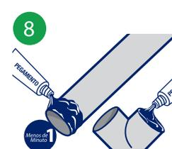
Aplique una capa delgada en el exterior del tubo y en el interior de la campana introduzca y manténgalos presionados para asegurar una buena distribución.
