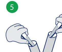
Retire las rebabas con lima por dentro y por fuera de la tubería.
