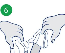
Luego use Limpiador y Reparador de superficies para preparar los extremos del tubo y del interior del accesorio.
