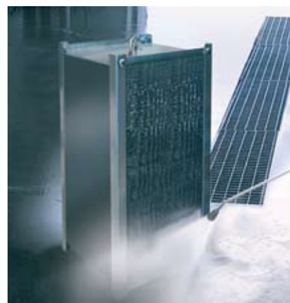
Iebūvētajā blokā iespējams iztīrīt cietvielas, izmantojot augstspiediena mazgātāju.
