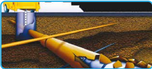
CAMBIO DE TUBERÍAS EXISTENTES SIN EXCAVACIÓN
