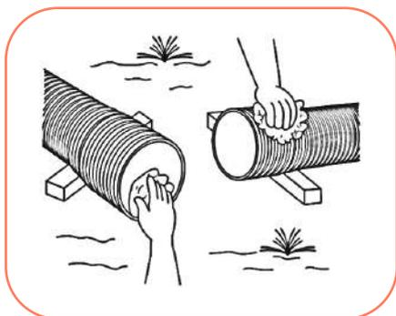
2º Realizar um calço nos tubos para evitar a entrada de corpos estranhos nas bolsas e nas pontas durante a execução da junta;
