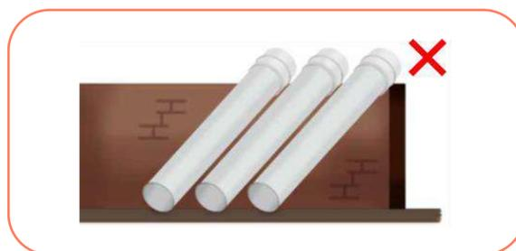
O armazenamento / estocagem dos tubos e conexões Amanco Wavin deve ser em locais isentos de quaisquer elementos que possam danificar o material tais como: superfícies rígidas com arestas vivas, objetos cortantes ou pontiagudos, pedras, etc.
