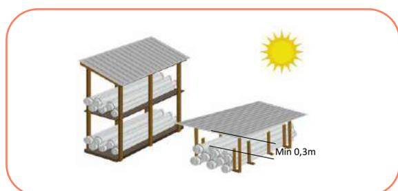
Caso utilize lona ou telas flexíveis (com por exemplo tela de monofilamento de polietileno de alta densidade com negro de fumo e percentual de sombreamento de 80%), garantir que haja um afastamento de no mínimo 30 a 50 cm na parte superior e laterais dos tubos para permitir a ventilação.
