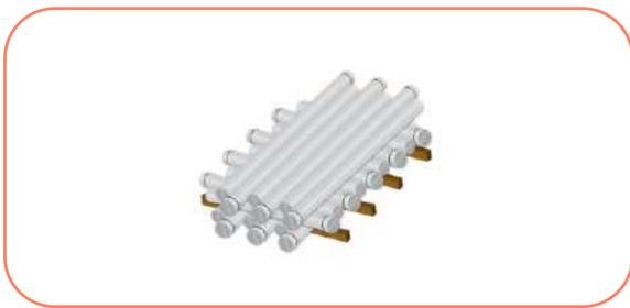
Realizado por meio da utilização de cruzamento longitudinal dos tubos para amarração das pilhas, sem a utilização de suportes laterais, utilizando sarrafos de madeira no sentido transversal a primeira camada espaçados de 1,5 m.
