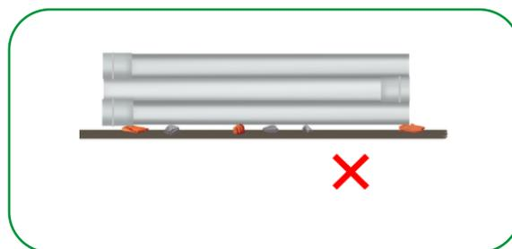
Admite-se um empilhamento com altura máxima de 1,50 metros, independente da bitola ou espessura dos tubos.
