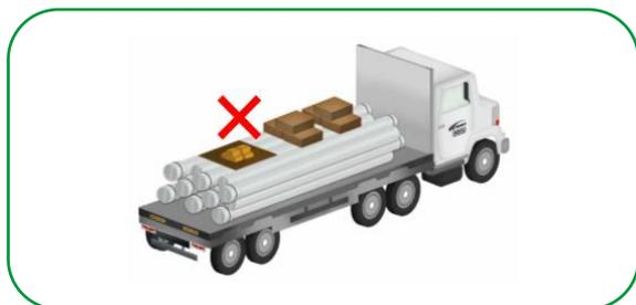
Evitar que parte da tubulação fique em balanço na carroceria principalmente em longos trajetos de deslocamento.
