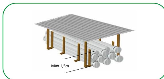
As barras de tubo devem ser dispostas em camadas, na forma horizontal a uma altura máxima de até 1,5 metros ou sobre pallets com empilhamento recomendável não superior a 2 unidades, não devendo ficar expostos a céu aberto por um período superior a 6 (seis) meses.
