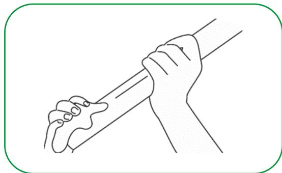
c) Aplicar com pincel uma camada uniforme de Adesivo Plástico PVC ou Solda Ultra Resistente Amanco Wavin na parte interna da bolsa da conexão e uma camada igual na parte externa do tubo.
