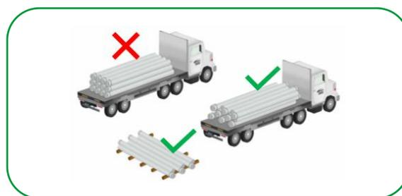
Para que as bolsas da primeira camada de tubos não fiquem em contato com o assoalho da carroceria, utilizam-se sarrafos para compensar a altura das bolsas, colocando em posição transversal aos tubos e espaçados em 1,50 m.
