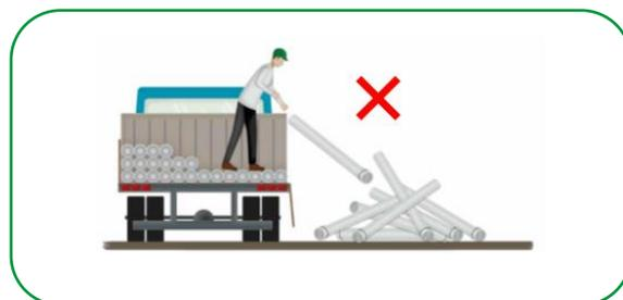
A tubulação suporta o manejo normal da obra e pode ser facilmente carregada/descarregada manualmente (diâmetros até 450mm) ou com equipamento (500mm até 1.000mm) fazendo uso de cordas ou cintas de nylon. O uso de qualquer material metálico, como correntes ou cabos de aço, NÃO é recomendado, pois pode danificar as tubulações.
