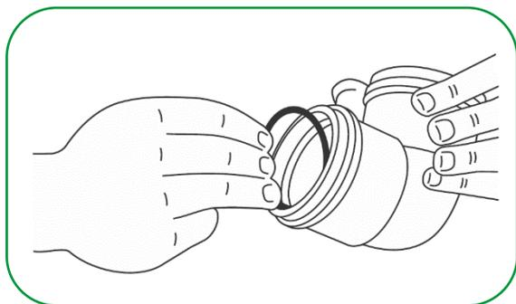
d) Aplique uma camada de Pasta Lubrificante Amanco Wavin na ponta do tubo e na parte visível do Anel de Vedação:
