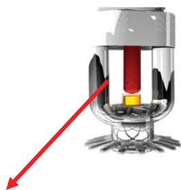
Ampola com 3 mm de diâmetro para sprinklers de resposta rápida, com ampola vermelha (68°C)
