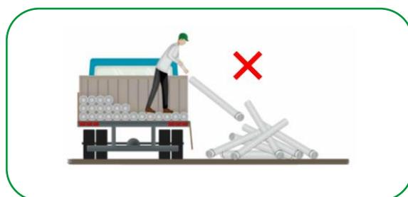
A tubulação suporta o manejo normal da obra e pode ser facilmente carregada/descarregada manualmente (diâmetros até 450mm). O uso de qualquer material metálico, como correntes ou cabos de aço, NÃO é recomendado, pois pode danificar as tubulações.
