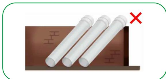
O armazenamento / estocagem dos tubos e conexões Amanco Wavin deve ser em locais isentos de quaisquer elementos que possam danificar o material tais como: superfícies rígidas com arestas vivas, objetos cortantes ou pontiagudos, pedras, etc.
