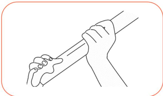
3º Aplique uma camada uniforme e sem excessos do Adesivo Plástico PVC Amanco Wavin primeiramente na bolsa da conexão e logo após na ponta do tubo. Para tubos e conexões de esgoto acima de DN75, utilizar o adesivo de PVC vermelho Amanco Wavin;
