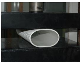
Cuando las muestras del **Novaducto TDP** se aplastan entre placas paralelas hasta el 40 % de su diámetro original, estas no evidencian fisuras, grietas, roturas o separación de sus paredes.
