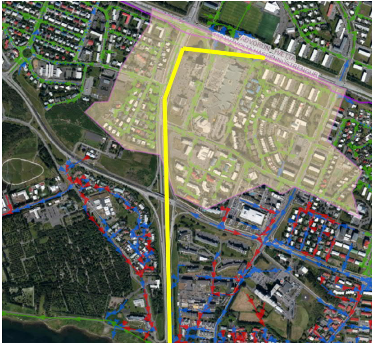
Mynd 6-10 Sjálfrennsli af svæði M-B um Kringlumýrabraut, lega og hæðarprófill
