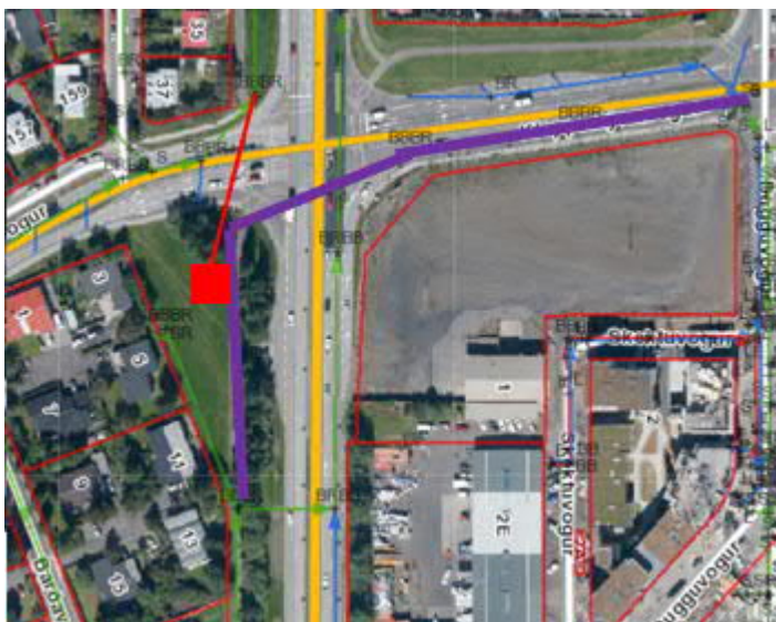
Mynd 5-9 Þverun S-C neðan Barðavogs, sökkkræsi og dælustöð (sökkkræsi fjólublá lína, dælustöð rauð lína)
