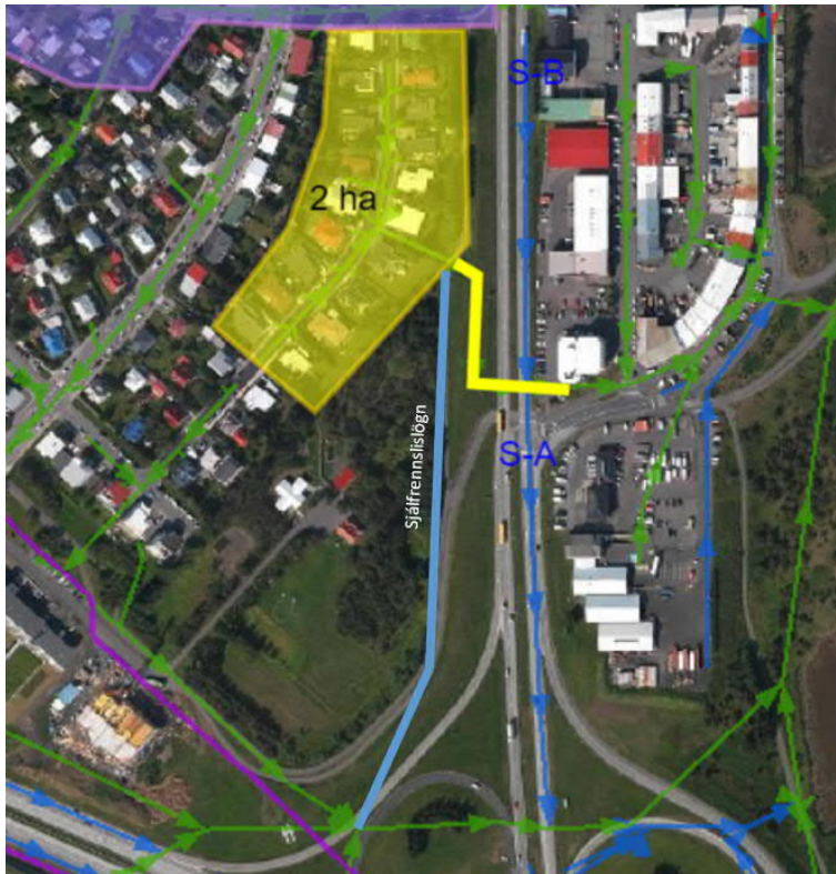
Mynd 5-4 Uppland þverunar S-A við Súðarvog. Afstöðumynd af mögulegri sjálfrennslislögn að Sogaræsi og sökkraesi við gatnamót Súðarvogs og Sæbrautar
