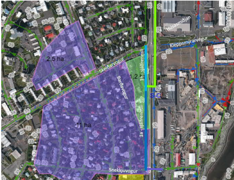
Mynd 5-8 Þverun S-C neðan Barðavogs, tveir möguleikar á sjálfrennsli (dökkblá lína 1a og ljósblá lína 1b)
