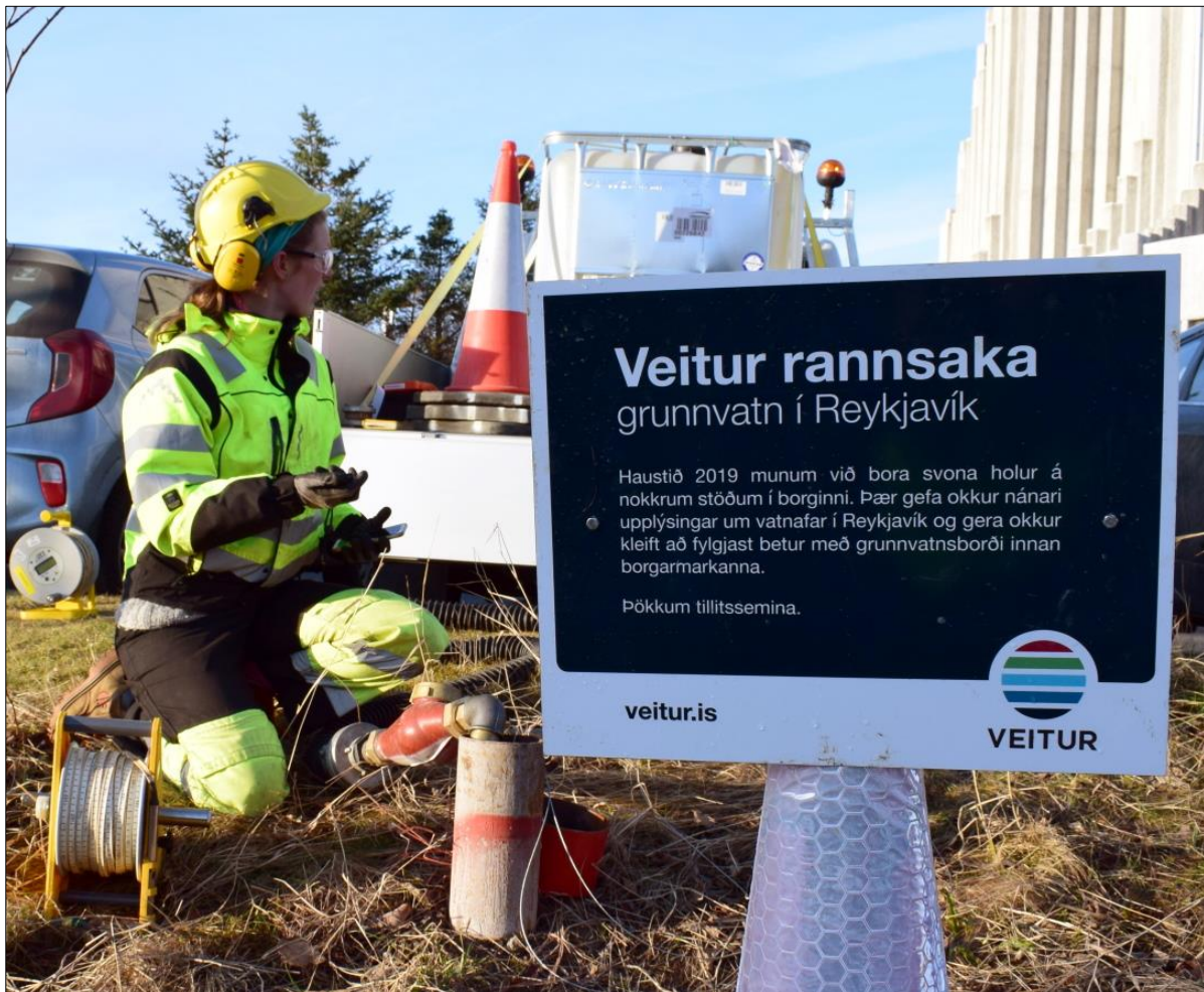
Mynd 1. Í september 2019 voru boraðar 9 grunnvatnsholur, GR-1 til GR-9, víðsvegar um Reykjavík. Hér er verið að gera mælingar í holu GR-3 á Skólavörðuholti.
