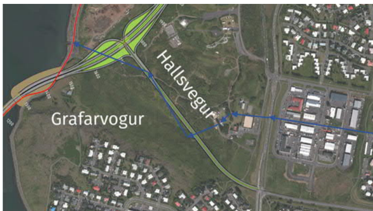
Mynd 7 Líkleg tenging Hallsvegur við Sundabrú á Gufunesi með mislægum gatnamótum. Bláar línur sýna núverandi regnvatnsstofn.
