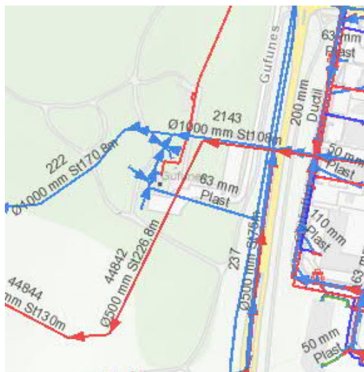
Mynd 13 Skjáskot af Lukor, fráveita, vatnsveita og hitaveita við Strandveg.
