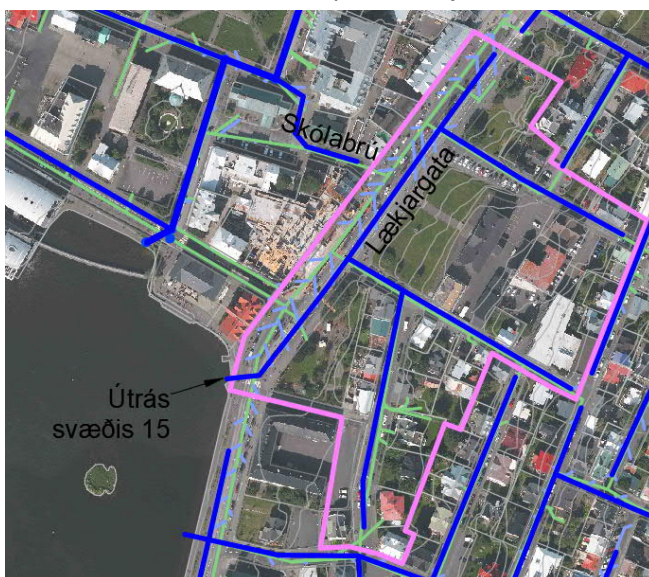
Mynd 28 Afrennissvæði 15 afmarkað með bleikri línu. Tillaga að nýjum regnvatnslögnum í dökkbláu.
