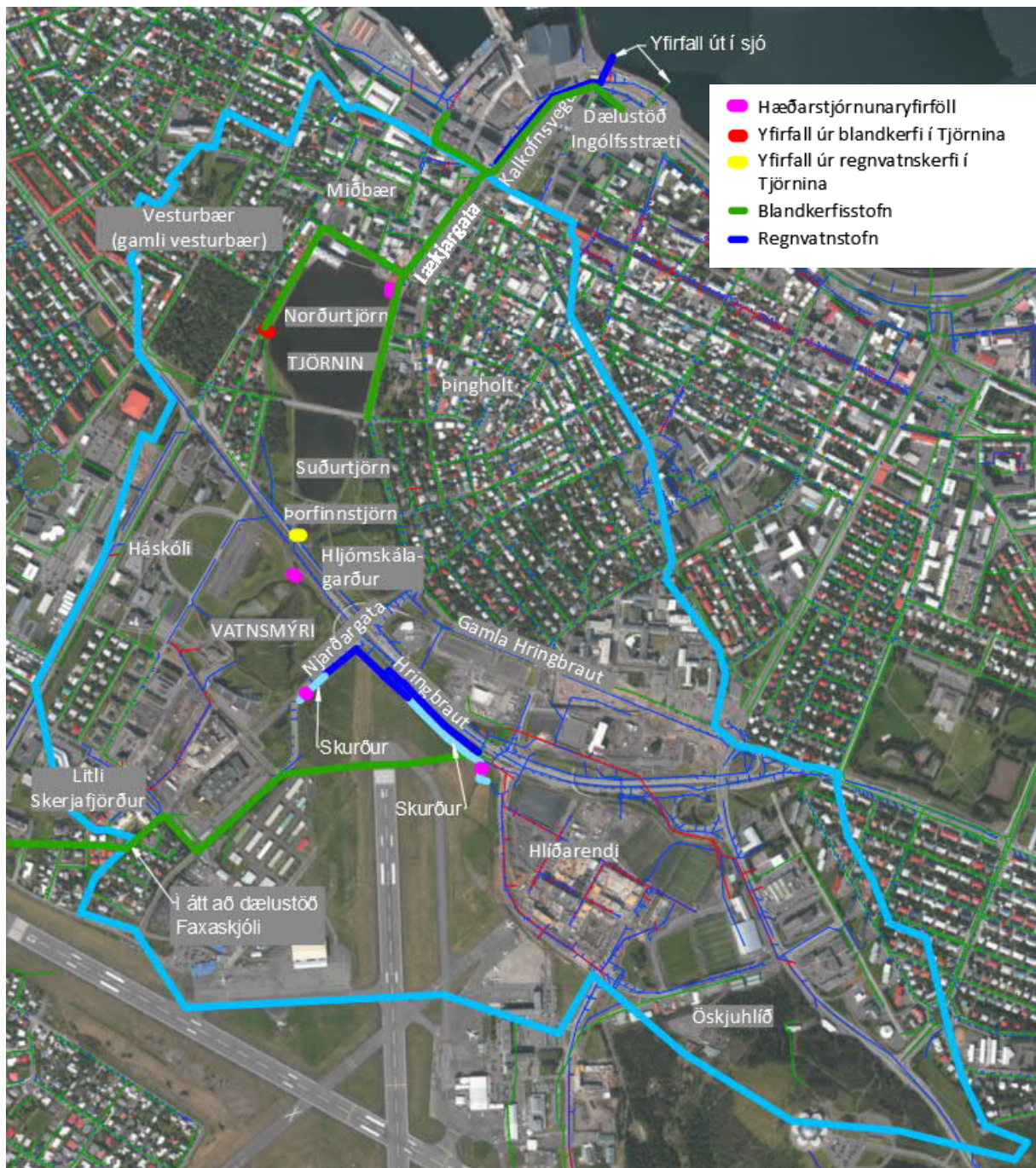
Mynd 1 Náttúrulegt afrennslissvæði Vatnsmýrarinnar og Tjarnarinnar í Reykjavík í ljósbláu, Núverandi lagnakerfi sýnt: blandlagirnir grænir (stofnar með þykkari línunum), skólplagnir rauðar, regnvatnslagnir bláar (regnvatnskerfi við flugvallarsvæðið og regnvatnslagnir í Lækjargötu-Kalkofnsvegi með þykkari línunum).
