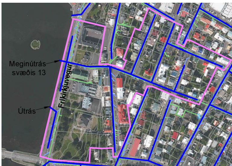
Mynd 26 Afrennissvæði 13 afmarkað með bleikri línu. Tillaga að nýjum regnvatnslögnum í dökkbláu.
