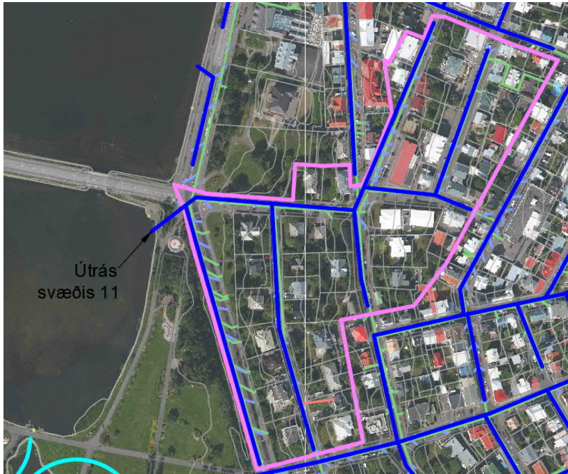
Mynd 23 Afrennissvæði 11 afmarkað með bleikri línu. Tillaga að regnvatnslögnum í dökkbláu.
