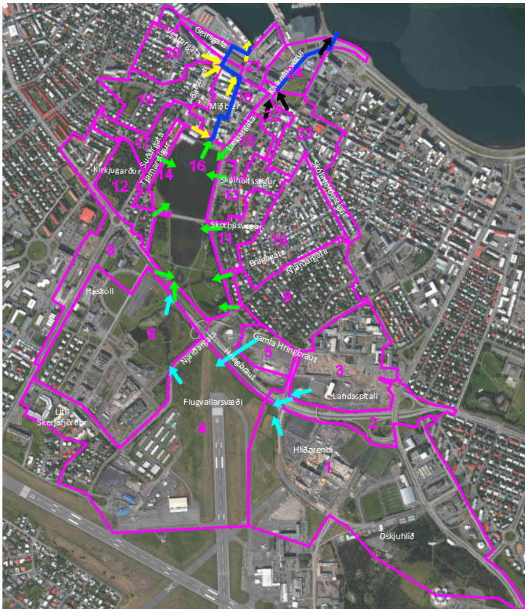
Mynd 9 Tillaga að nýju regnvatnskerfi: skipting afrennissvæða (bleikt) og útrásar punktar með örvum, ný útrás Tjarnar (blá til vinstri), regnvatnslögn Lækjargötu (blá til hægri). Afrennissvæði: í Vatnsmýrarsvæði með ljósbláum örvum, í Tjörnina með grænum örvum, í nýja útrás Tjarnar með gulum örvum, í regnvatnslögn í Kalkofnsveg með svörtum örvum.
