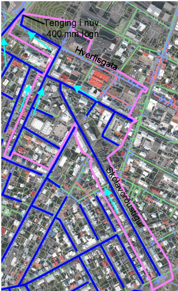
Mynd 36 Afrennissvæði 23 afmarkað með bleikri línu. Tillaga að nýjum regnvatnslögnum í dökkbláu. Afrennislíttir sýndar með örvum.
