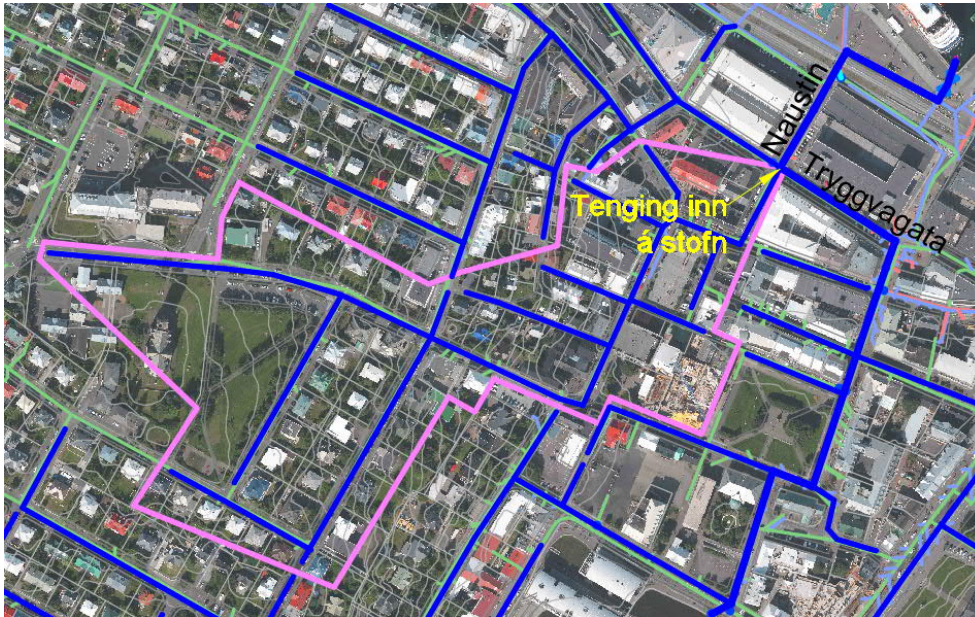
Mynd 32 Afrennissvæði 19 afmarkað með bleikri línu. Tillaða að nýjum regnvatnslögnum í dökkbláu.
