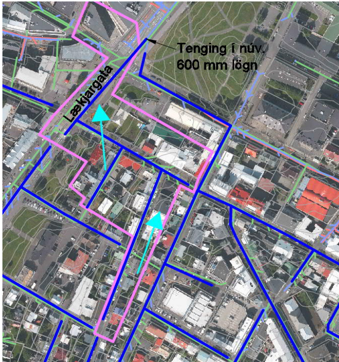
Mynd 35 Afrennissvæði 22 afmarkað með bleikri línu. Tillaga að nýjum regnvatnslögnum í dökkbláu. Afrennissáttir sýndar með örvum.
