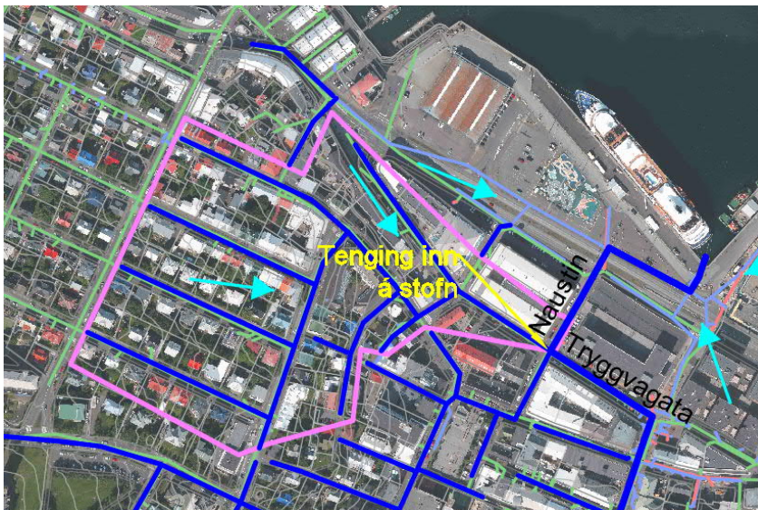
Mynd 33 Afrennissvæði 20 afmarkað með bleikri línu. Tillaða að nýjum regnvatnslögnum í dökkbláu. Afrennissáttir sýndar með örvum.
