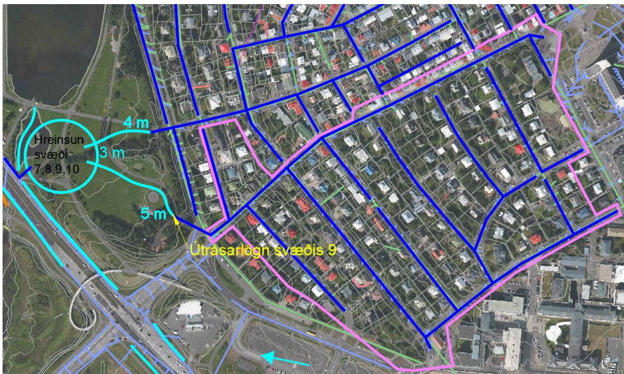
Mynd 21 Afrennissvæði 9 afmarkað með bleikri línu. Tillaga að nýjum regnvatnslögnum í dökkbláu, ofanvatnsrásir með áætluðum hæðum og svæði fyrir hreinsun í ljósbláu (cyan).
