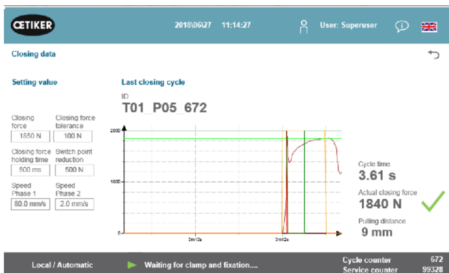
Слика 78: Крива вучне силе процеса затварања
