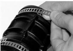
Medir el diámetro a sujetar y determinar la longitud de la banda añadiendo 50 mm al diámetro medido. (Longitud de la banda = Diámetro + 50 mm).
