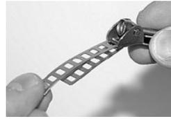
Introducir un extremo de la banda por arriba a través de la ranura de retención y guiarlo hacia atrás unos 30 mm por debajo de la banda.
