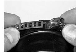
Colocar la banda alrededor de la pieza a sujetar, posicionando su extremo libre sobre los ganchos y por debajo del tornillo. Este extremo se sitúa así debajo del cuerpo del tornillo. Enganchar los ganchos en la posición más ajustada posible.
