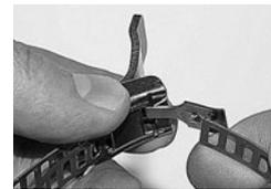
Colocar la palanca en posición abierta y adaptar el extremo de la banda libre a la curvatura del cierre de trinquete. Introducir este extremo ya conformado, por debajo de la lengüeta a través de la ranura, situándolo por encima del cuerpo del cierre.
