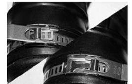
Colocar la banda alrededor de la pieza a sujetar. Presionar sin esfuerzo el extremo libre hacia abajo y mover la palanca hacia detrás y hacia delante hasta tensar la conexión. Fijar la palanca en su posición cerrada. La muesca de retención evita que la conexión se abra casualmente.
