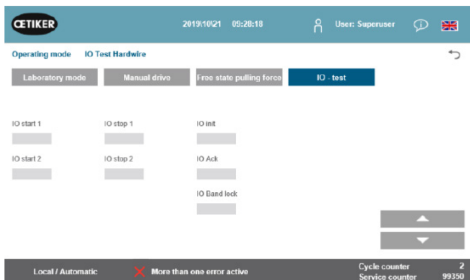
Fig. 85: IO Testați semnalele de ieșire digitale de intrare
