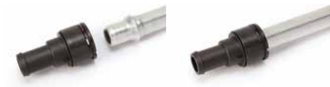
Pour la déconnexion, enclencher ou placer l'outil de déconnexion sur le tube avec les doigts face à l'attache. Faire glisser l'outil de déconnexion sur le tube et engager l'anneau de retenue. Tourner l'outil de déconnexion sur 60 degrés pour étendre l'anneau de retenue. En maintenant l'outil de déconnexion contre l'attache, tirer pour la déposer.
