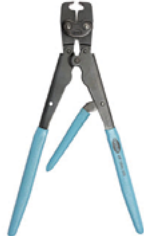
Handmontagezange für Ohr Klemmen, die eine Schliesskraft von \geq 2000 N erfordert
