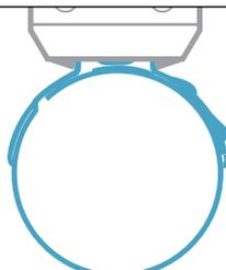
2. Zangenbacken am Klemmenohr ausrichten
