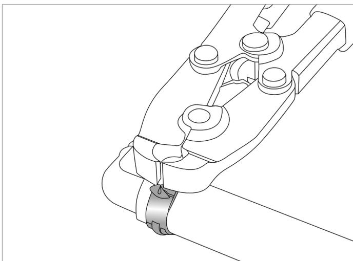
3. 切断しクランプを外します
