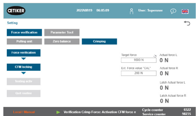
ภาพประกอบ 57: การตรวจสอบแรงอัด
