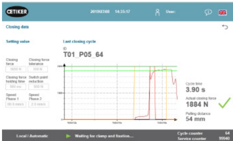
ภาพประกอบ 78: กระบวนการปิดเส้นโค้งแรงดึง
