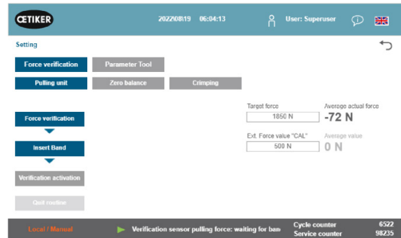
ภาพประกอบ 52: ตรวจสอบแรงดึง
