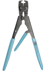
Alicates de instalação manual para abraçadeiras de orelha que requerem força de fechamento \geq 2000 N
