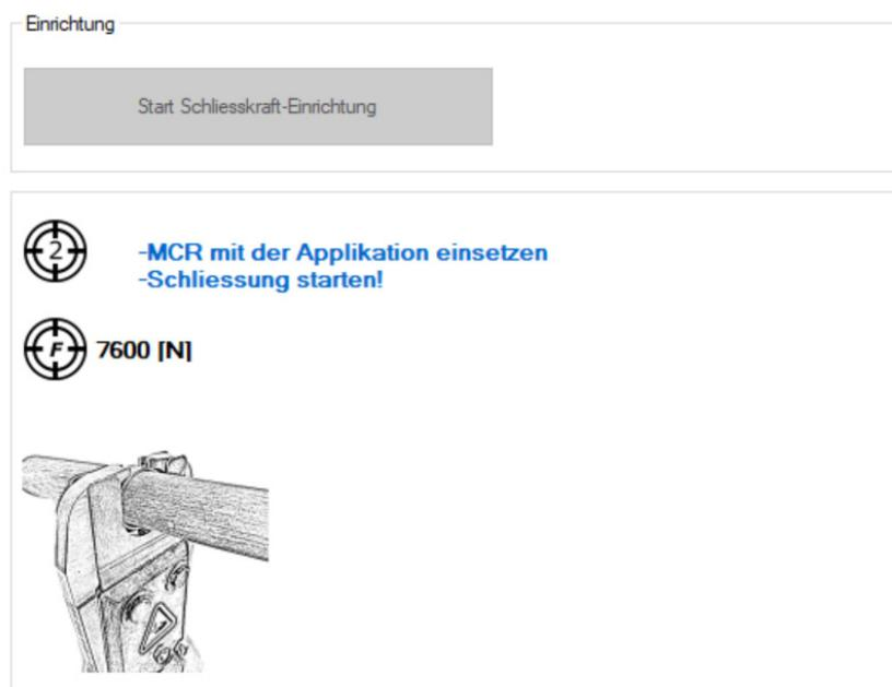
15. Vorgang solange wiederholen, bis MCR Schliessung inkl. Applikation (Rundheit MCR) vollständig und innerhalb akzeptabler Rundheit von  $\pm 0.2$  mm ist
