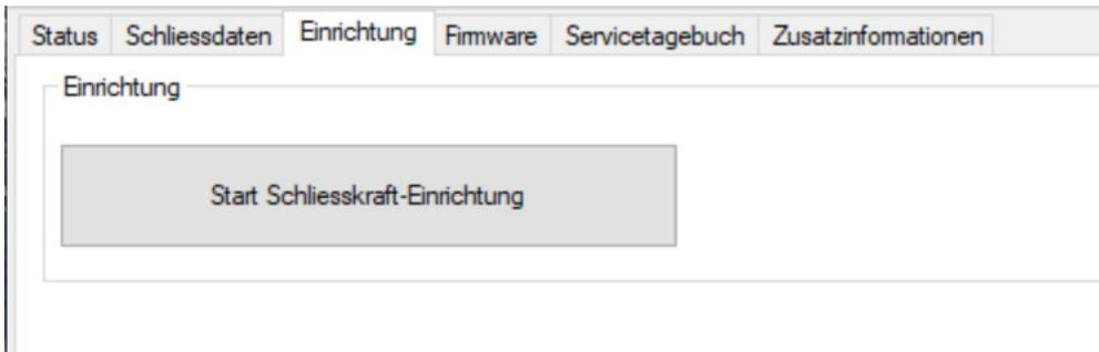
2. Drücken Sie den Knopf «Start Schliesskraft-Einrichtung»
