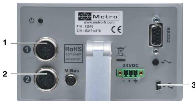
Fig. 13 Prises du connecteur de l'écran (vue arrière)
