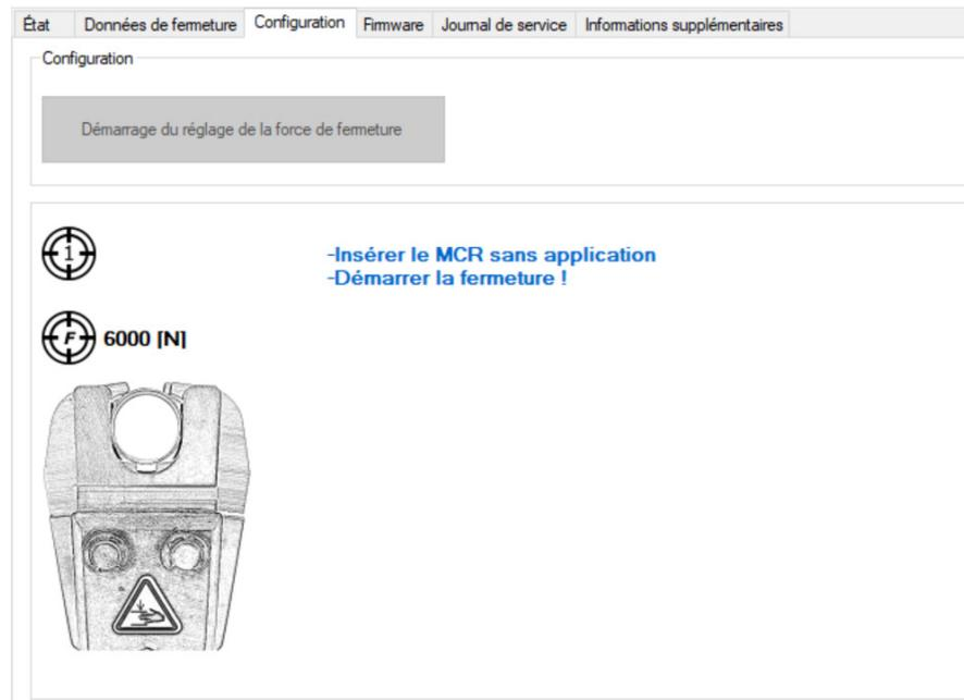
9. Répétez la procédure jusqu'à ce que la fermeture de la bague à rétreindre (circularité de la bague à rétreindre) soit complète et dans les limites de la circularité acceptable de  $\pm 0,2$  mm
