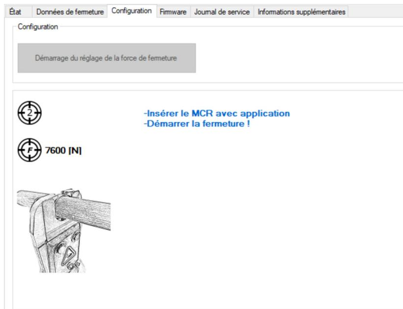
15. Répétez la procédure jusqu'à ce que la fermeture de la bague à rétreindre avec application (circularité de la bague à rétreindre) soit complète et dans les limites de la circularité acceptable de  $\pm 0,2$  mm
