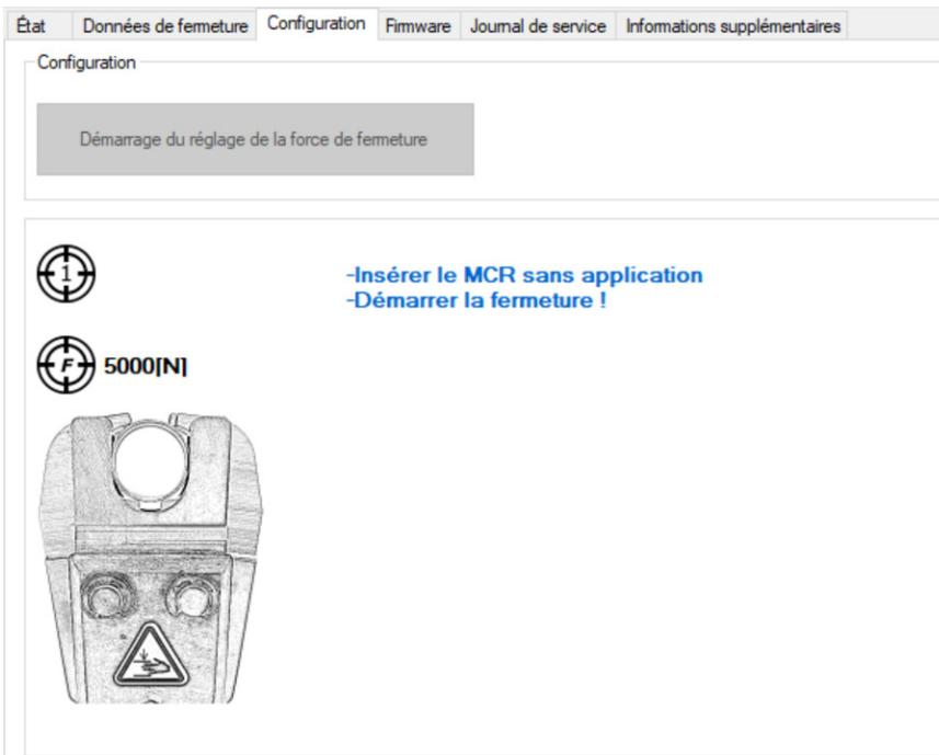
5. Insérez la bague à rétreindre sans application et effectuez une fermeture complète. Cette première fermeture commence toujours par une force de poussée minimale de 5000 N.
