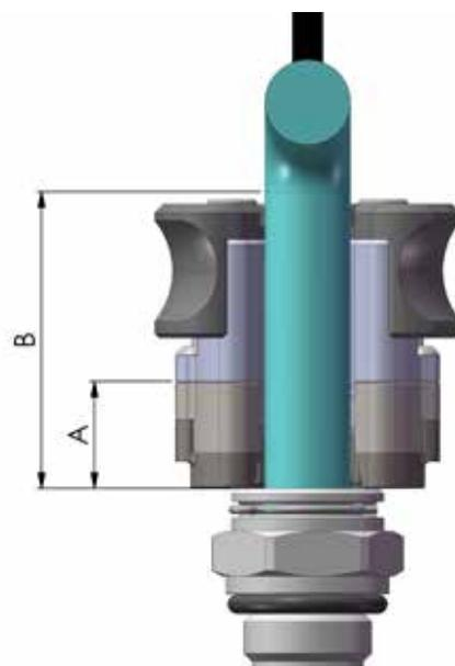
**Remarque :** Les coudes de tube peuvent augmenter le diamètre du tube, ce qui peut interférer avec l'assemblage du tube dans l'unité de tête.
