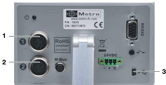
Fig. 13 Prese del connettore del display (vista posteriore)
