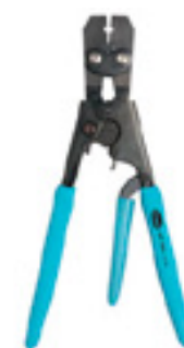
Pinze per applicazione manuale di anelli a crimpatura multipla
