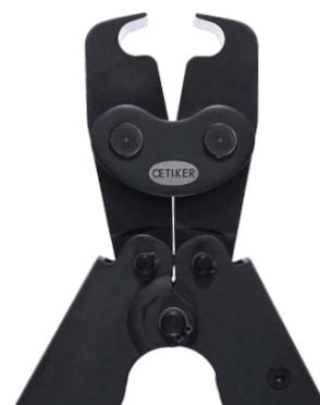
革新的な力監視機能付きの新しいクランプ締付け工具「Oetiker SMART」は、自動車業界アフターマーケットにおける Oetiker クランプの簡単かつ正確な締付けをサポートします。一般的な調節式イヤークランプの正しい締付け力を知らせるように特別に設計されています。この工具には3つの締付け力 (1800、2400、および 3800 N) があり、使用前に選択できます。内蔵センサーにより、この工具は事前に設定した力に達すると、LEDライトおよび振動信号で力を知らせます。
