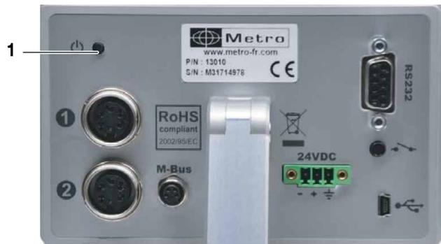
Abb. 14 Ein/Aus-Schalter der Anzeige (Rückansicht)
