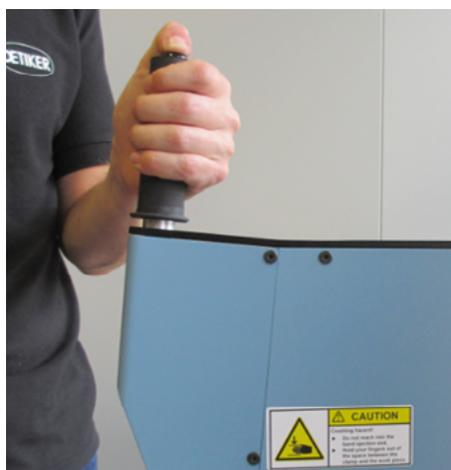
Fig. 8 Botón en la parte superior de la empuñadura
