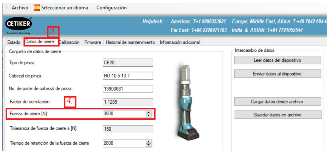
Fig. 31: Ajuste predeterminado de la fuerza de cierre
