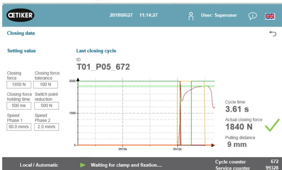
Fig. 78: Curva de fuerza de tracción de proceso de cierre
