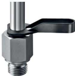
Pour déconnecter, enfoncer la douille de déconnexion dans le Quick Connector jusqu'à la butée, maintenir dans cette position et retirer le tube ou l'about.
