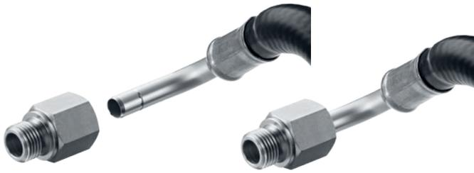
Pour assurer la connexion, enfoncer le tube ou l'about à gorge dans le Quick Connector jusqu'à l'encliquetage. Il est recommandé de vérifier que chaque tube est correctement inséré à l'aide d'un test de traction manuel.
