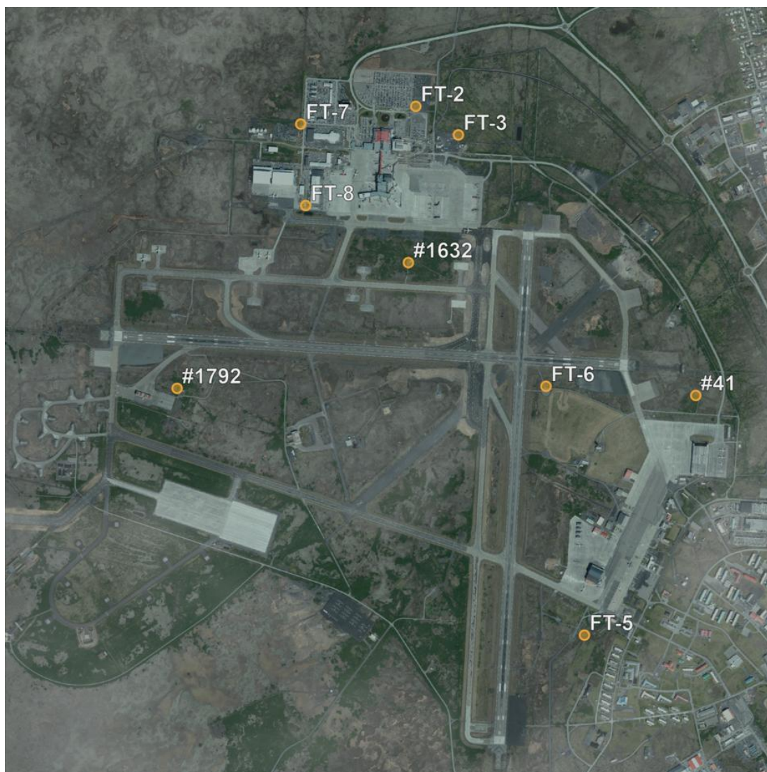
Mynd 8. Staðsetning borhola. Staðsetning var valin þannig að mælingar endurspegli heildarástand grunnvatns á flugvallarsvæðinu (Verkís, 2018).
