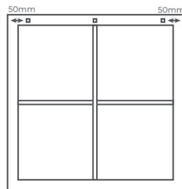
Hier werden die Halterungen angebracht. Verteilen Sie zusätzliche Halterungen in gleichmäßigem Abstand.
