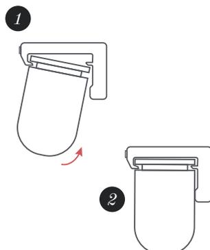
Drücken und kippen Sie die Kopfschiene, bis sie einrastet.
